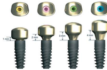
Figure 12: Hauteurs supra-implantaires des vis iphysio® sur implant Bone Level
